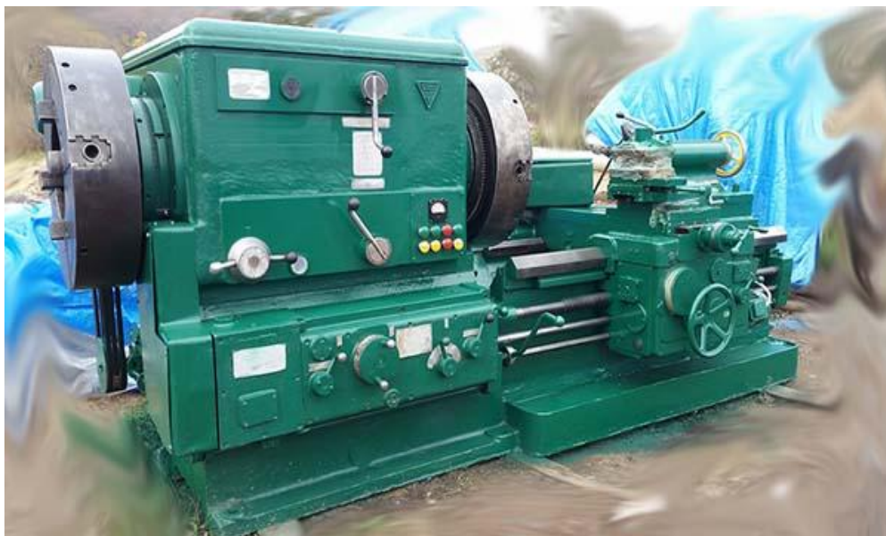
تصویر دستگاه رزوه‌زنی لوله با دو چهارنظام، مخصوص صنعت نفت، مدل 1H983
